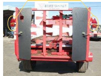
後部反射器及び灯火器類の設置例
