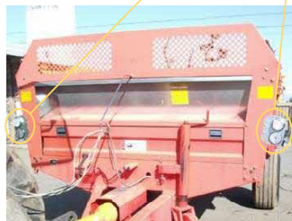
後部反射器及び灯火器類の設置例
