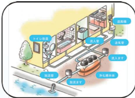
住宅や併用住宅（事務所と併用している住宅）毎に個別に合併処理浄化槽を設置し、流しや風呂・トイレなど生活排水を処理して道路の雨水管などに放流します。
